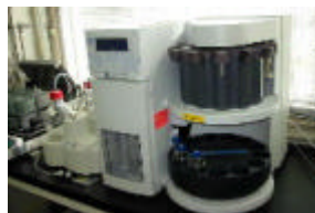
高速溶媒抽出装置
