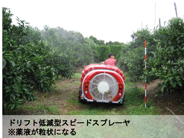
写真1 スピードスプレーヤーの違いによる散布薬液の飛散状態の比較
