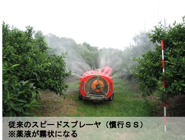
写真1 スピードスプレーヤーの違いによる散布薬液の飛散状態の比較
