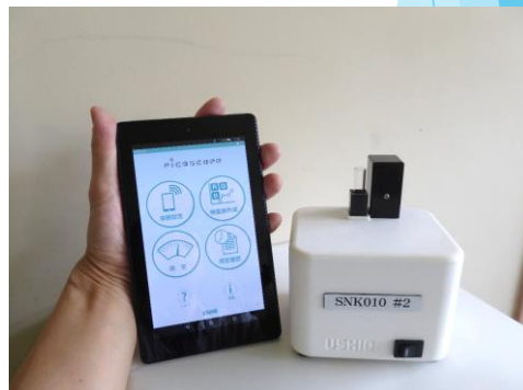
従来蛍光光度計の1/50 (容積比) サイズ (ウシオ電機調べ)
