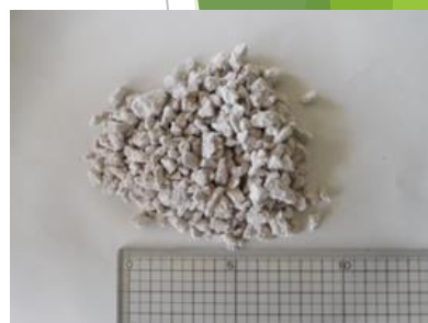
写真1 細かく砕いた軽量気泡コンクリート (ALC)
