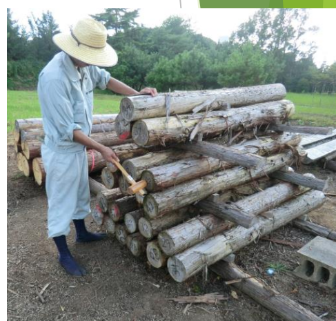
写真1 はえ積みヒノキ丸太の固有振動数の測定状況
