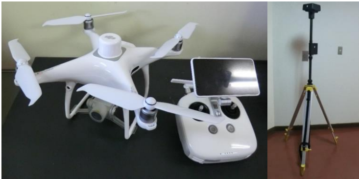
写真1 測量用ドローン (PHANTOM4RTK、左) と 基地局 (D-RTK2、右)
