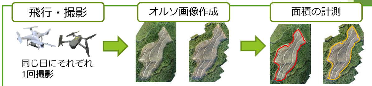
図1 試験の流れ ※面積の計測は、岩や切り株を目印にして行った
