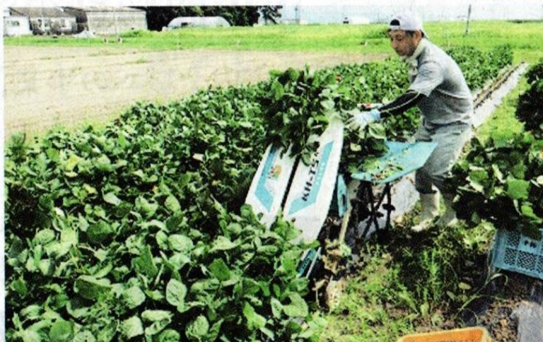
パレイシヨ茎葉処理機を利用したエダマメの収穫
