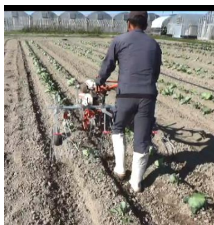
写真 21 歩行型管理機装着型除草装置（左：除草機部分、右：作業の様子）
