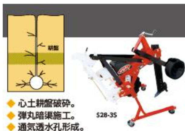
写真14 バイプロサブソイラ (ニプロカカタログより引用)
