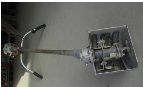
写真 24 遠心式除草装置（刈刃部分）
