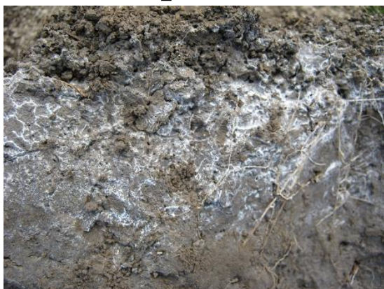
写真3 植物根の跡を通った水の跡(白く見えるのは石灰水が通った後)
