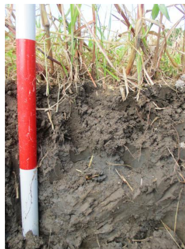
写真9 ソルガムの根の広がり（干拓部門P3）圃場、左：心土破碎施工、右：無処理（2020年5月8日播種、10月6日撮影）
