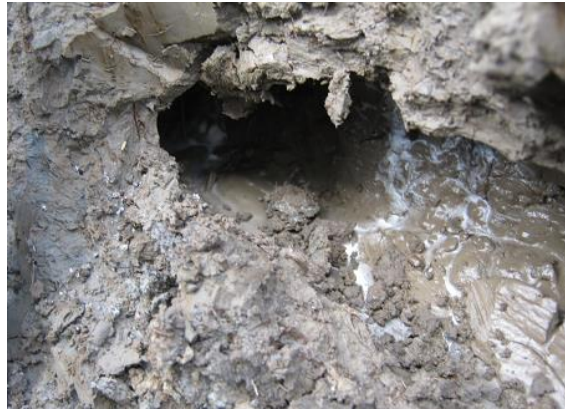
図6 明きょと浅層弾丸暗きょの接続 写真15 上から石灰水を流して排水の様子を確認 (白色が石灰水の流れた跡)
