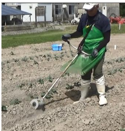
写真 25 遠心式除草機による除草作業（左：通常の作業姿勢、右：縦持ちでの作業）
