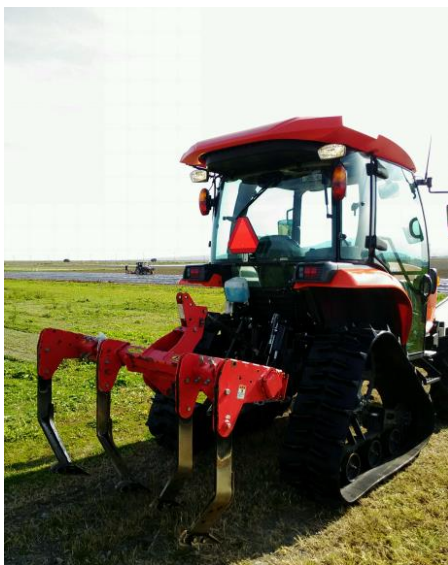
写真 11 作業機・パラソイラ (撮影 2018年11月)
