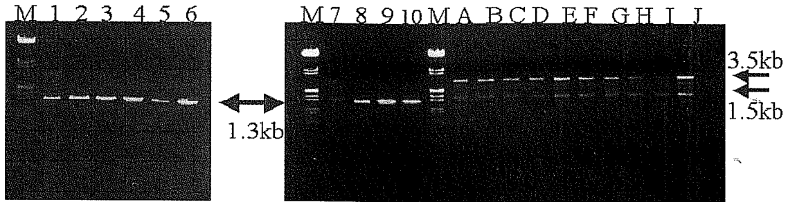
図7 シルバーリーフコナジラミ活成虫の推定保毒虫および非保毒虫単体からの P-PCR キットによる TYLCV 検出 (TY プライマー利用)
