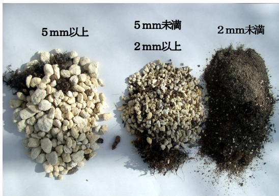
写真5 培養土の粒子径別の割合 (未使用)
