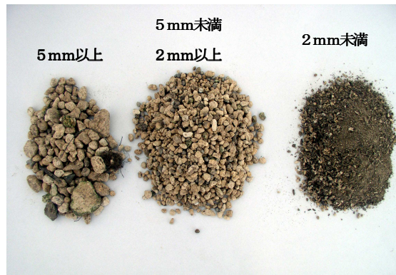
写真6 培養土の粒子径別の割合 (10作目)
