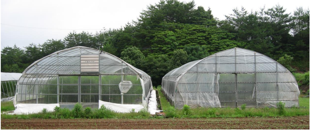
写真9 試験場内における試験圃場：ビニルハウス妻面開放区（左）と対照圃場：慣行区（右）
