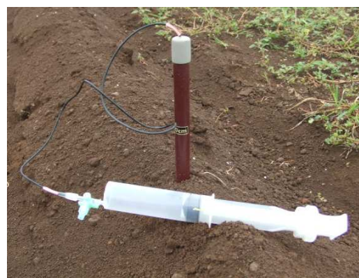
写真1 土壌溶液の採取 (ミズトール)
