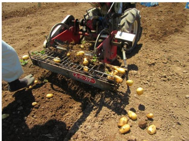
写真3 横送りコンベアの衝撃による損傷
