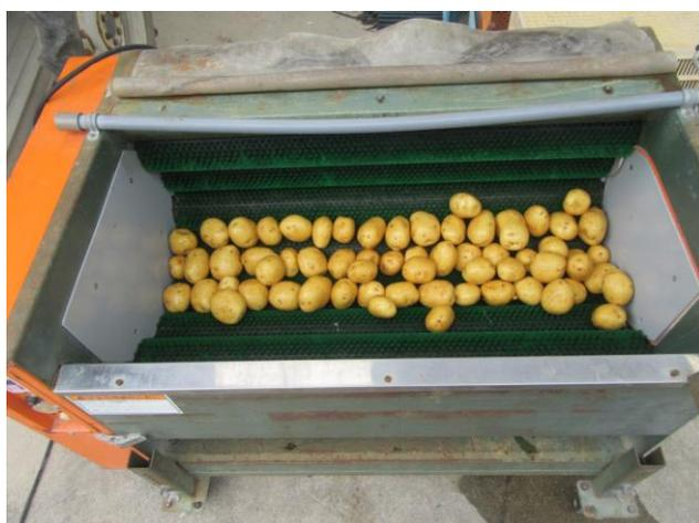
写真4 野菜洗浄機の摩擦による皮剥け
