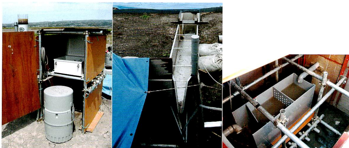
図3 観測機器(左:地表水用採水器、中:地表水用HSフリューム、右:暗渠排水用三角セキ)
