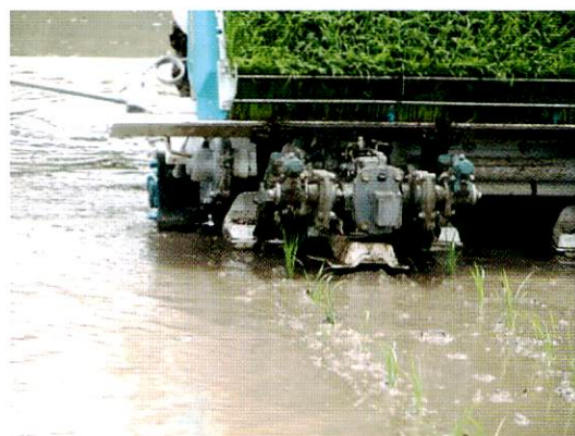
写真6 2週間苗の田植機による移植
