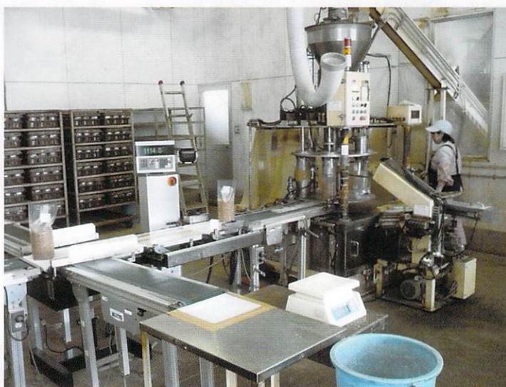
(写真2) 培地を充填する機械
