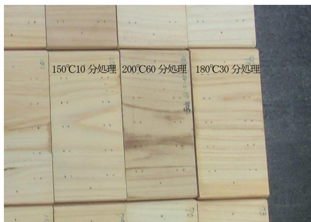
写真1 処理条件別に圧密処理した試験体
