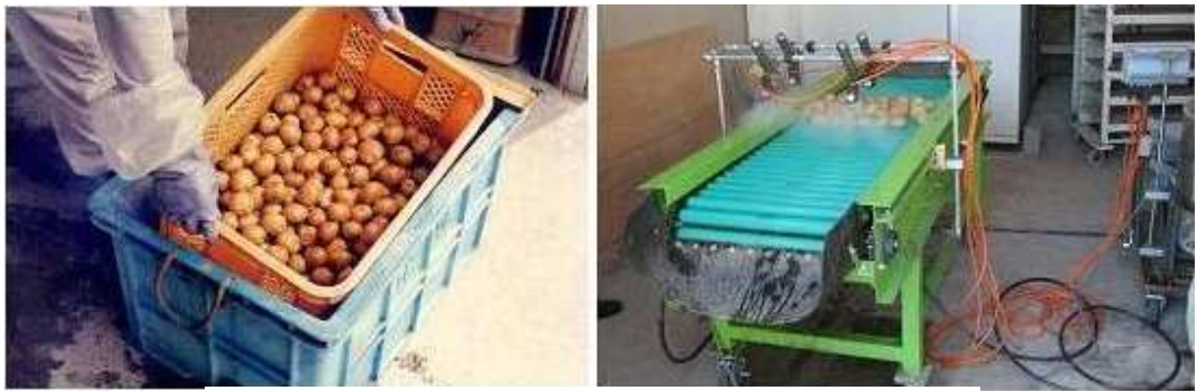
図1 種いも消毒 浸漬処理（左）と噴霧処理（右）
