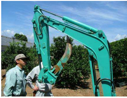
写真1 断根刃の装着状況
