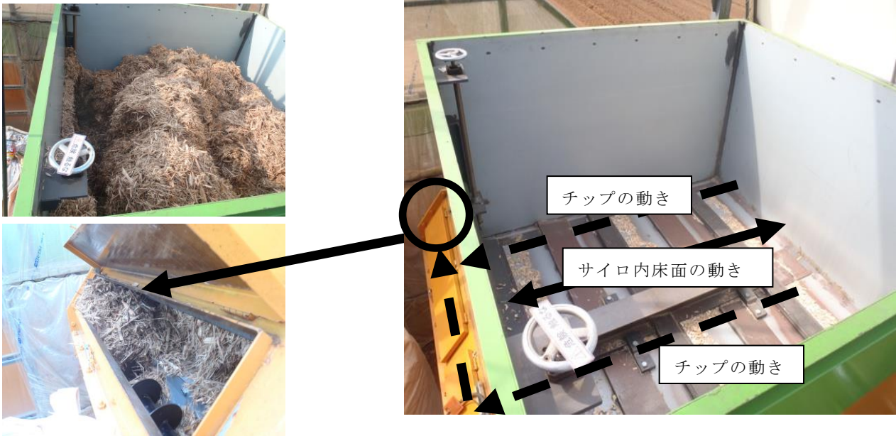
図1 燃料サイロ内とスクリーン搬送装置の状況
