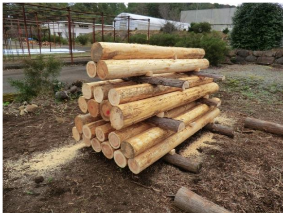
写真 1 剥皮あり・栈木ありの状態
