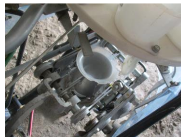
図1 試作品の苗ガイド(中央)と移植機への装着状況
