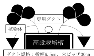
図 専用ダクト配置場所
