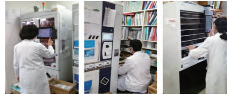
散剤秤量ロボット 全自動錠剤分包機 錠剤自動仕分け機 調剤機器の活用を通じて業務の効率化を進めています。
