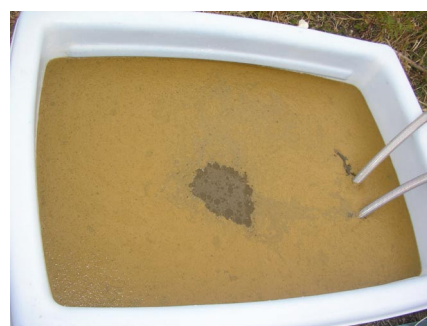
液体凝集剤8+加圧浮上
