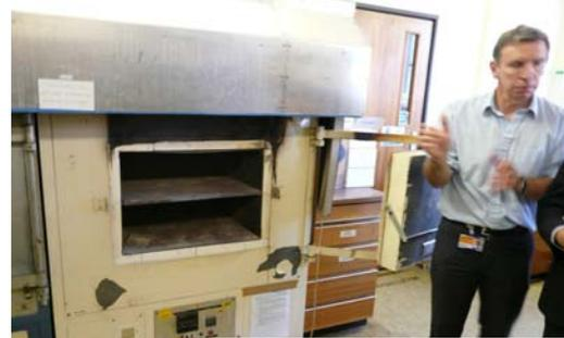
灰化を行うための電気炉
