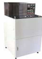
写真1 廃食油再生燃料化装置(BDF装置)
