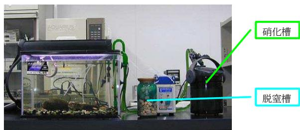
実験装置 (水槽, 脱窒槽および硝化槽)
