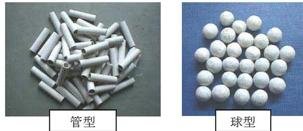
図4:①の方法で作成された浄化資材
