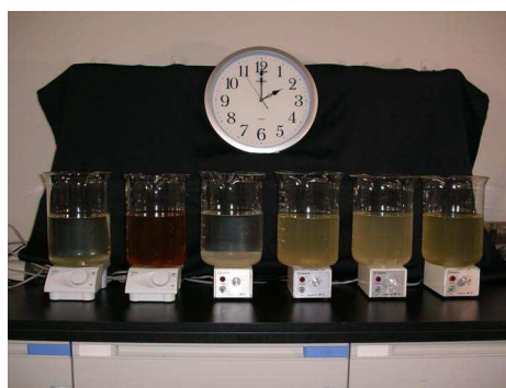
左から順に、凝集剤6 5mL、凝集剤7 5mL、凝集剤8 5mL、凝集剤1 1g、凝集剤2 1gおよび対照
