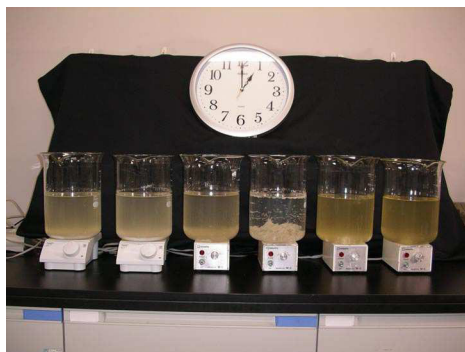
左から順に、凝集剤1 10g、凝集剤2 10g、凝集剤3 10g、凝集剤4 10g、凝集剤5 10gおよび対照
