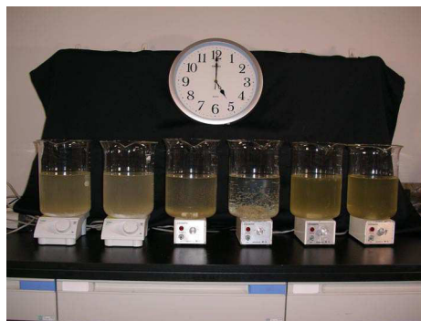
左から順に、凝集剤1 5g、凝集剤2 5g、凝集剤3 5g、凝集剤4 5g、凝集剤5 5gおよび対照
