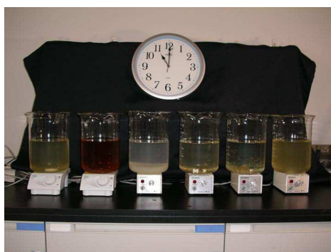
左から順に、凝集剤6 10mL、凝集剤7 10mL、凝集剤8 10mL、凝集剤3 1g、凝集剤4 1gおよび対照
