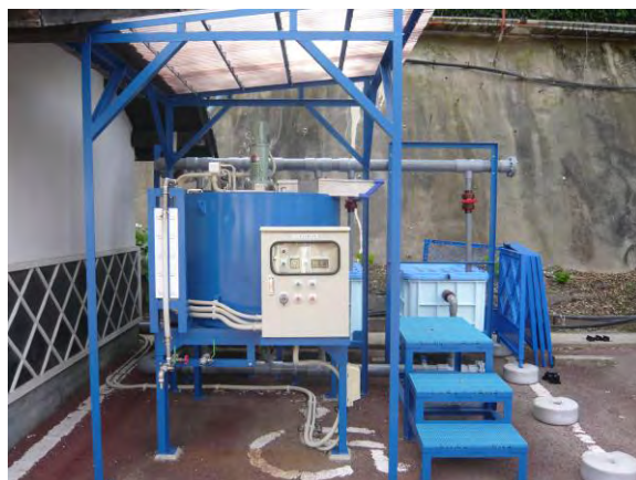
図 2 余熱利用型 BDF 製造装置
