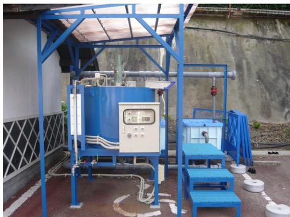
図 2 余熱利用型 BDF 製造装置
