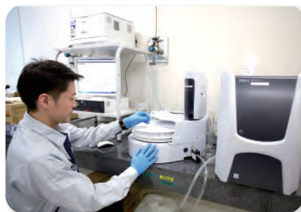
TOC計(全有機体炭素計)で、海水や河川水の有機物量を計測しています
