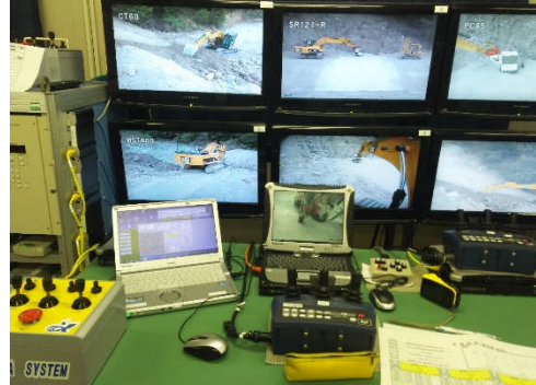
遠隔操作（GPS）による出来形管理
