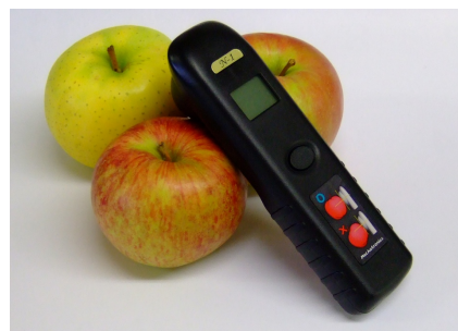
図2 世界最軽量の非破壊糖度計
