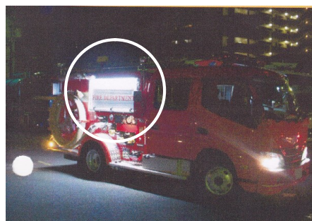
図4 消防車両用LED照明
