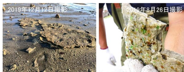
図 2b 森園の覆砂区で見られる板状の固化体(左写真)。再生砂の原料であるガラス片が固化しているのが分かる(右写真)。
