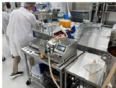
タンクから充填機本体を通してペットボトルへ充填される
