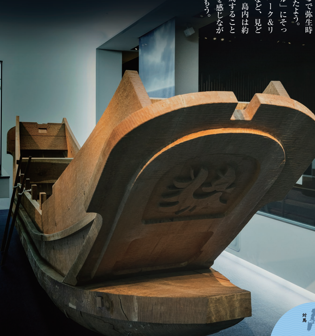
一支国博物館に展示されている古代船の実寸模型。 今から約2000年前、大陸や朝鮮半島の人々は、準構造船と呼ばれる古代船で、一支国に至る海の道を往来していた。
