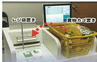
農産物対応型RFID無人レジを開発(商品の読取精度100%を実現)
