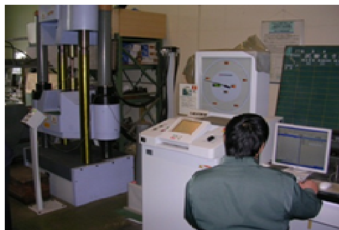
図1 設備開放による引張試験
