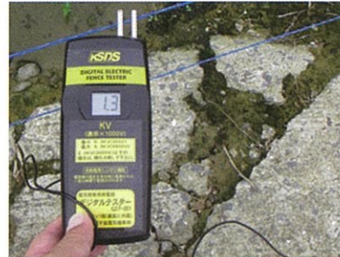
コンクリートで計測した場合【1.3KV】
