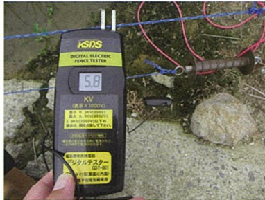
土で計測した場合【5.8KV】
