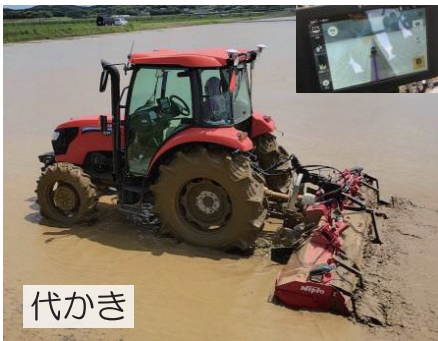
自動操舵（直進アシスト）トラクター
