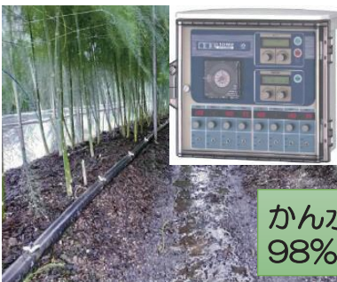
タイマー式自動灌水装置
