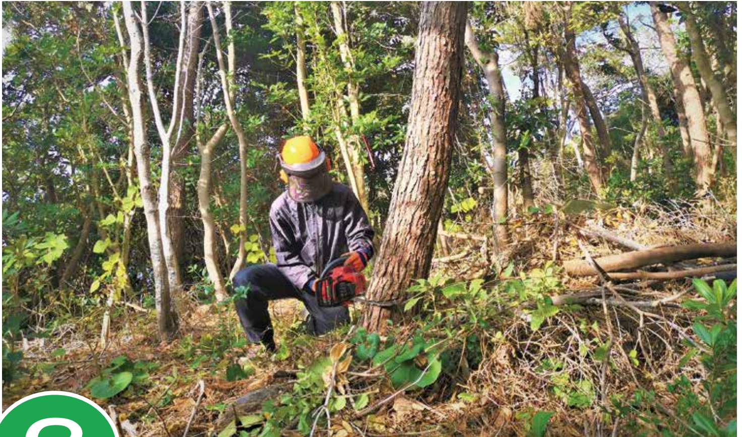
下肢の切創防止用保護衣を着用して伐倒中 壱岐市森林組合 西永さん
