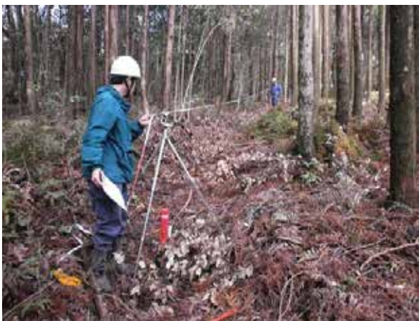
コンパスによる測量状況
