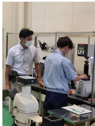
ロックウェル硬さ試験の実習
