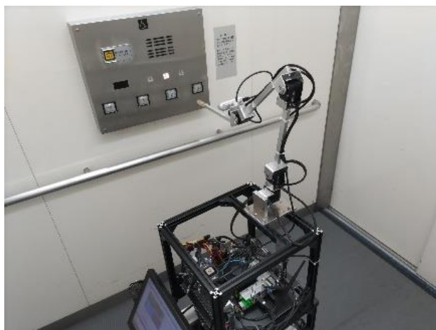
エレベータを操作可能な移動ロボット
