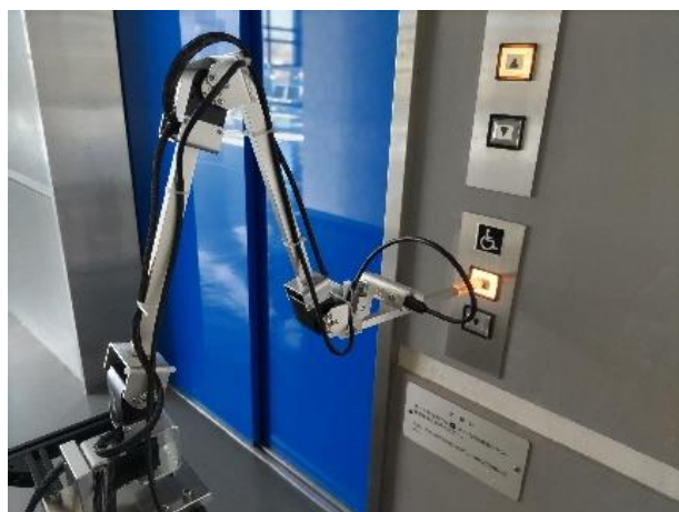
エレベータを操作可能な移動ロボット
