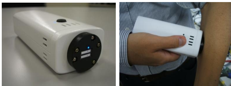
図 3. リンパ浮腫の早期診断装置の外観。リモコン並みの重量 179g (電池含) とサイズ 55(W)×38(H)×133(D)を実現。
