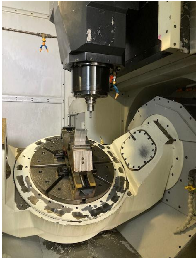
傾斜面加工状況
