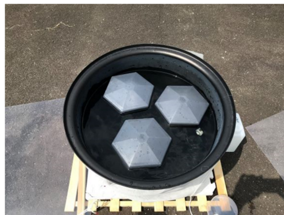
図2 水槽Bに浮かべた遮光資材
