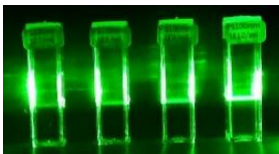
散乱光による粒子数の簡易判定
