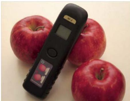
①携帯型の非破壊糖度計
