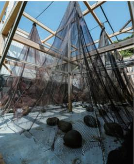
店の入口にある立体塩田。海水を循環することで水分を蒸発させる。塩づくりの装置。こうした自然の力を利用して塩づくりをしているのはとても珍しいという。
