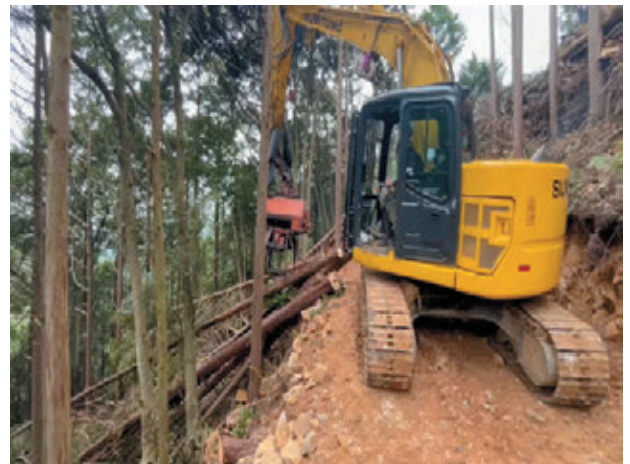
高性能林業機械での集材・造材作業の実演
