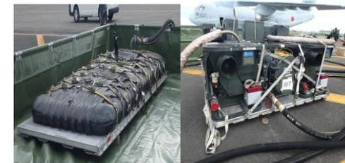
可搬型燃料タンク、可搬型給油装置
