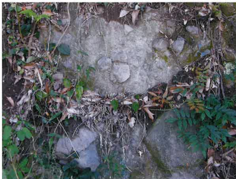
写真 4.1.1 彼杵川左岸、調査地より下流の崖に露出する凝灰角礫岩
